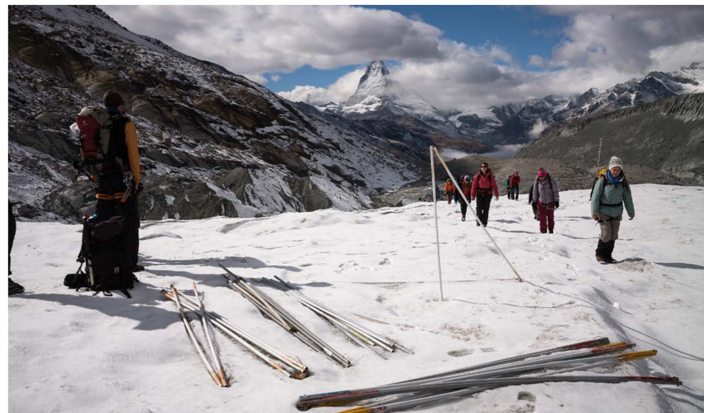
Ablationsmessung, Findelengletscher – Schweiz. Foto: H. Machguth.
