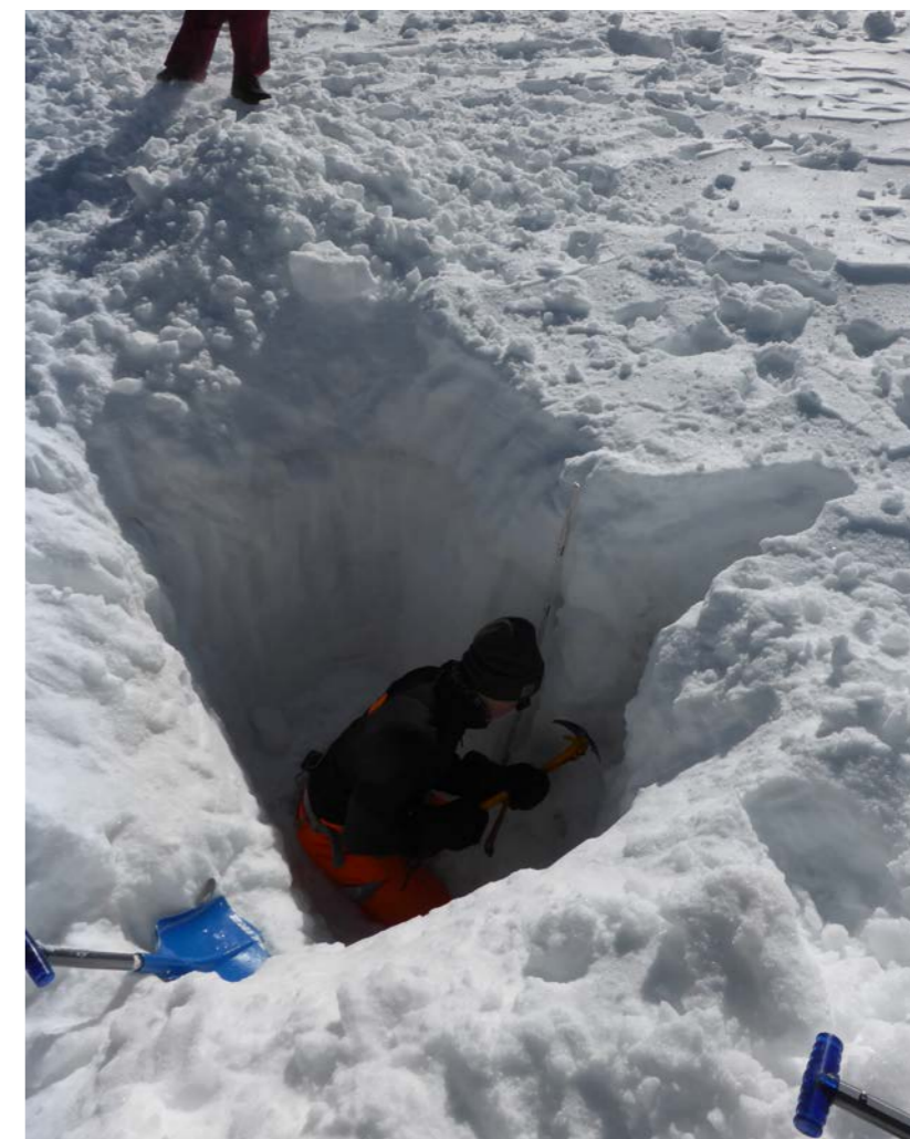
Akkumulationsmessung, Klein Matterhorn-Schweiz. Foto: S. Nussbaumer.
